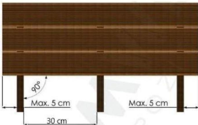
Ako se daske postavljaju pod kutem 90° gledajući na podkonstrukciju, ona može biti najdalje 5cm od ruba daske. U suprotnom lako dođe do loma daske. razmak među podkonstrukcijama ne smije prelaziti 30 cm.
